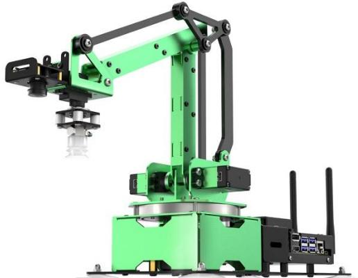
El **JetMax** es un brazo robótico inteligente impulsado por la potente **NVIDIA Jetson Nano**, diseñado para investigación, enseñanza y desarrollo de aplicaciones en **inteligencia artificial, visión computacional y robótica avanzada**. Basado en el sistema operativo **ROS (Robot Operating System)**, ofrece una arquitectura abierta y altamente programable mediante **Python, C++ y JavaScript**.
